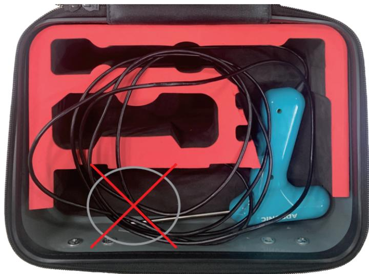
鏡頭未擺放在正確位置無法得到確實的保護，可能導致鏡頭損壞
