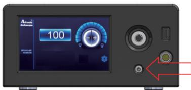
10.5 安裝光纖：將光纖導束接頭插入接口至最底部即可，接口內有固定裝置防止光纖脫落。
