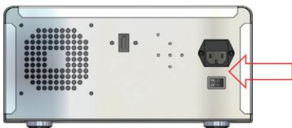
10.2 啟動電源：將總電源開關切換至ON位置，並開啟前方電源開關，此時光源輸出。
